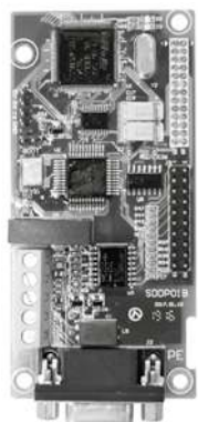
Карта протокола Profibus SDDP01 для ESQ-760 (для ПЧ от 5.5 кВт и выше)
