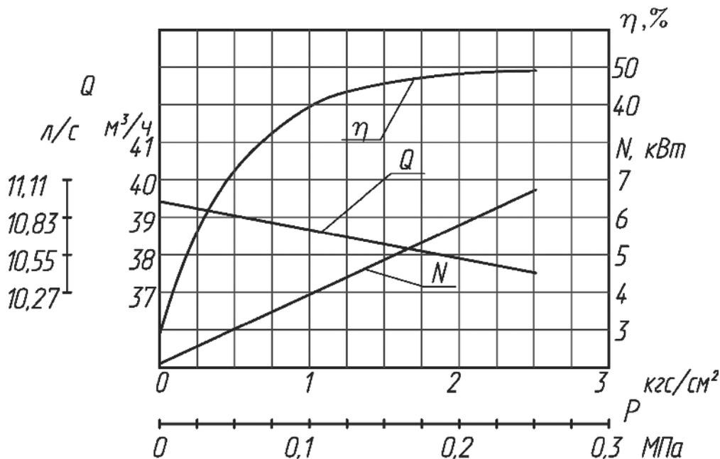
Характеристика электронасосных агрегатов (насосов) типа Ш80-2,5-37,5/2,5
