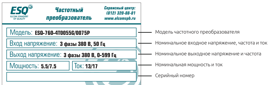
Рисунок 2-4. Изображение шильды частотного преобразователя ESQ-760
